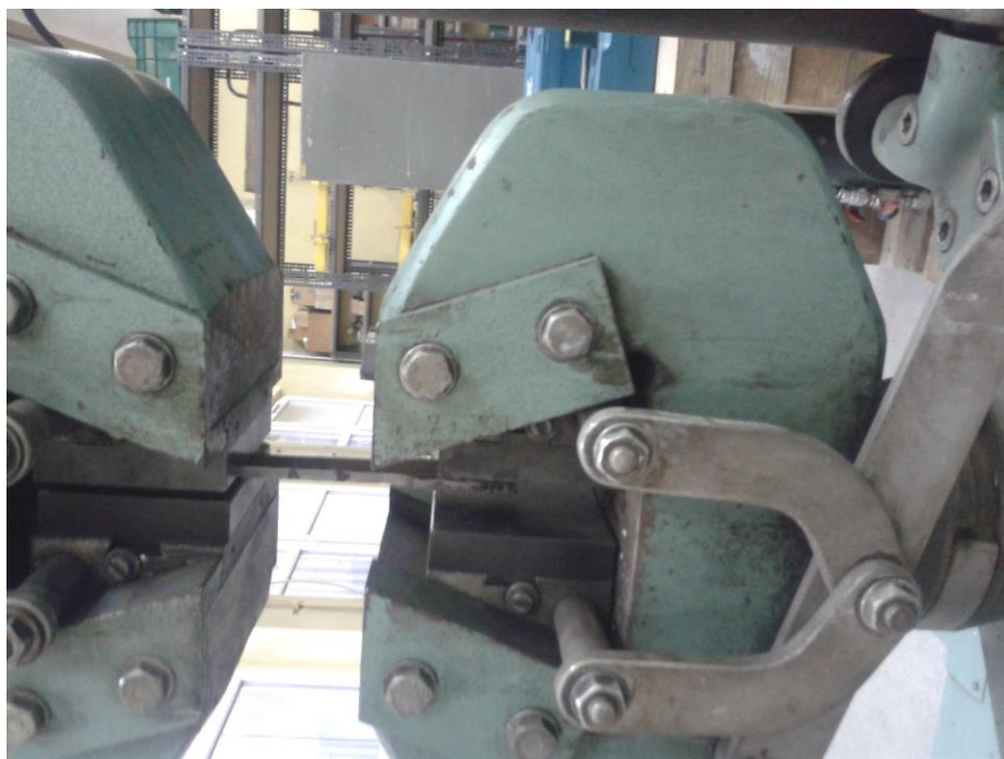
Rys.Z2.2. Próbkę w maszynie wytrzymałościowej
